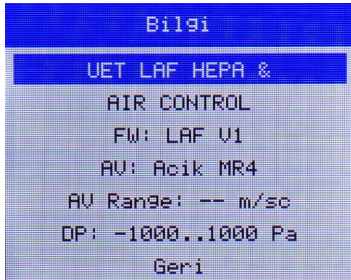
Şekil 21 - Bilgi ekranı; firmware, hava hızı sensörü ve DP aralığı.
