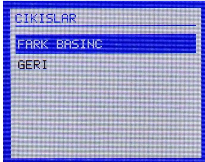
Şekil 14 - Çıkışlar menüsünde Fark Basınç seçimi.
