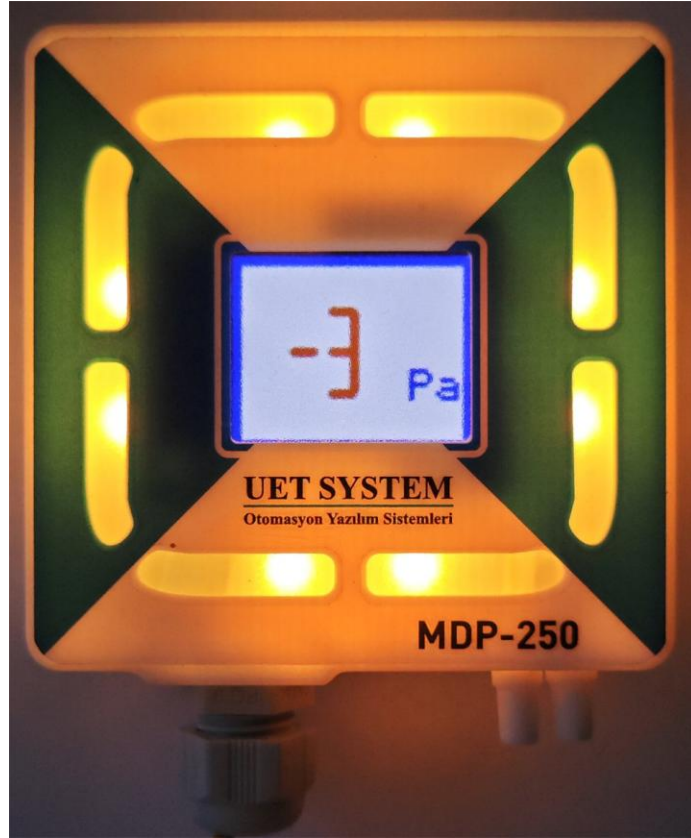
Şekil 7 - Alarm rengi örneği; negatif basınç alarm durumu.
