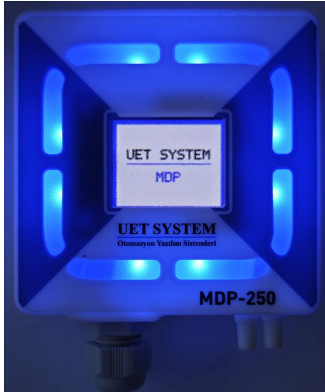
Şekil 6 - Bekleme veya normal çalışma LED görünümü.
