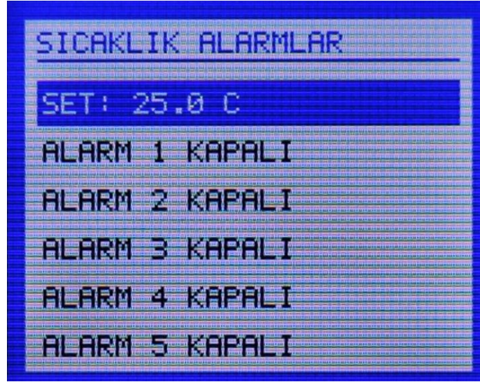
Şekil 9 - Sıcaklık alarmları listesi ve set değeri.
